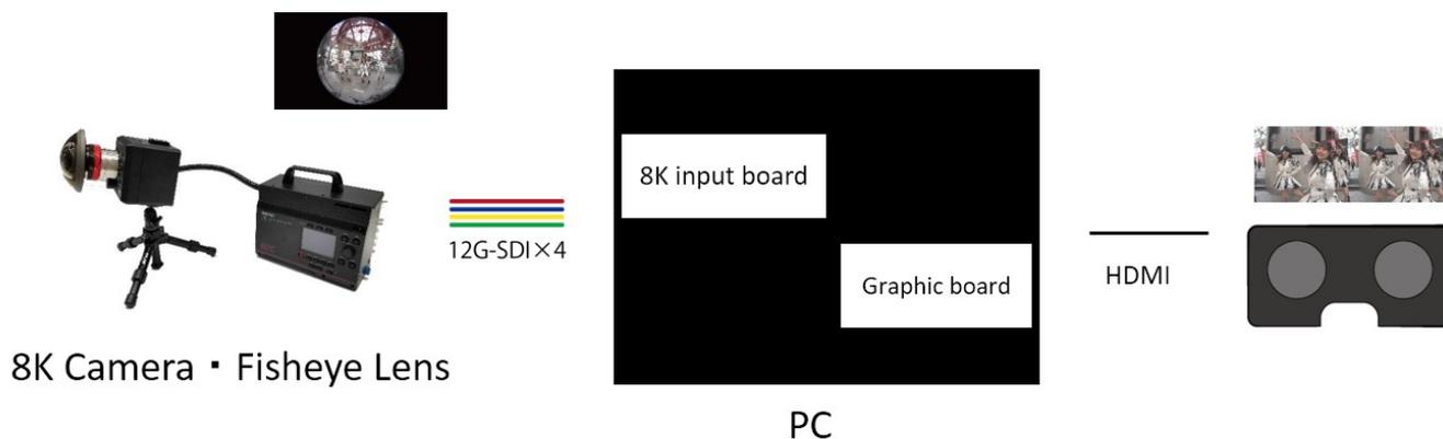
8K カメラ 2 台によるリアルタイムステレオ VR を実現。魚眼レンズとの組合せにより、高解像度かつスティッチングなしの 8KVR 映像を撮影します。
